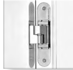
Tectus Band TE 340 3D F1 Die verdeckt liegenden 3D TECTUS-Bänder haben einen Öffnungswinkel von 180° (Verstellbereich seitlich +/- 3 mm, Höhe +/- 3 mm, Andruck +/- 1mm)
